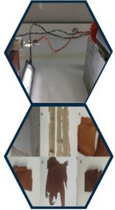
Elektrosipin İşlemi ve Üretilen Karbonnanofiber Yapılar
