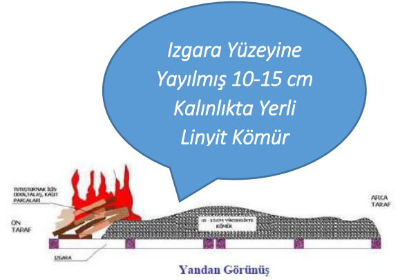
Şekil 1 Izgara Yüzeyine Kömürün Yayılması ve Ateş Kapağı Önünden Tutuşturulması
