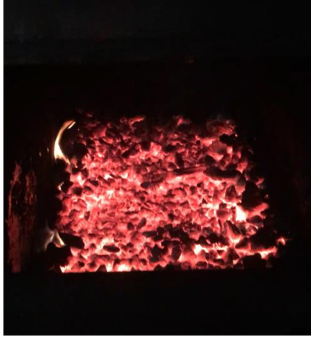
Fotoğraf 3 Kızartma - Serpme İşlemi Sonrasında Izgara Yüzeyi Boyunca Tutuşma ve Korlaşma
