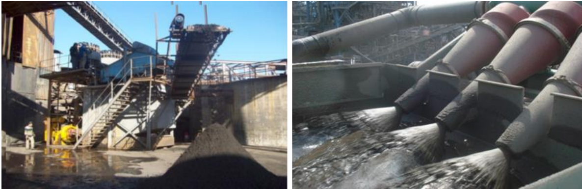
Ömerler Lavvarı MSG ve Soma'da Kurulan HI-G Dryer İnce Ebatlı Kömür Kazanım Üniteleri
