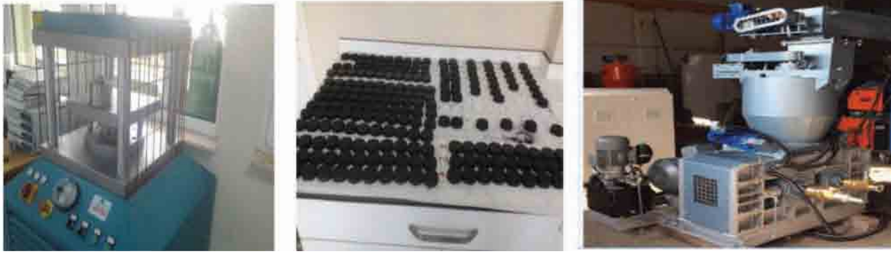
Şekil 49. Laboratuvar ölçekli 10 tonluk hidrolik piston pres (sol) , elde edilen briketler (orta) ve 36 tonluk pilot ölçek roller pres
