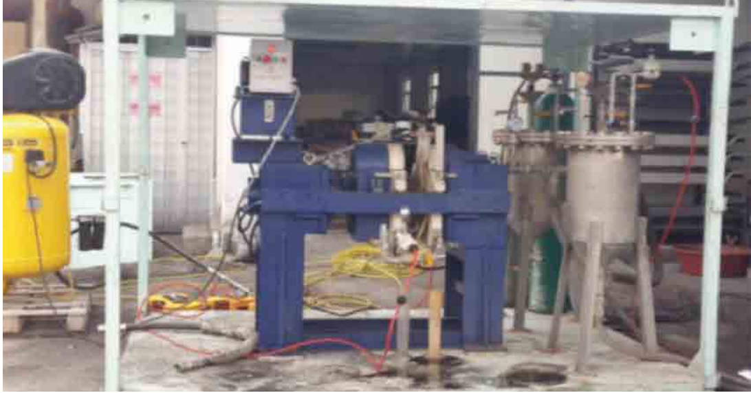
Şekil 51. Susuzlandırma Amaçlı Pres Pilot Test
